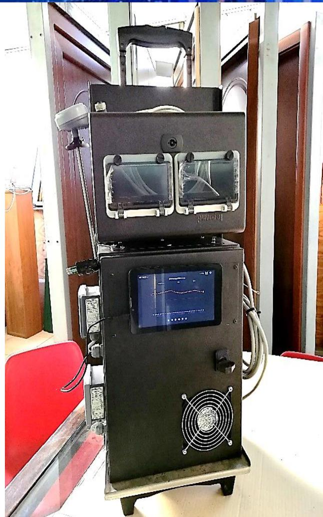
**ANALISI E MONITORAGGIO IN REAL TIME: Indice Qualità' Aria, VOC, PM 1,2,5,4,10, CO2, U/T, Luminosità**
