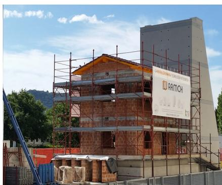
In alto: Esecuzione di test sismico all'Università di Brescia su edificio in muratura in scala reale senza intervento di consolidamento (test di riferimento)
