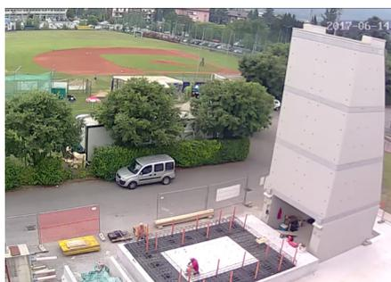
In alto: Strong wall per sollecitazioni orizzontali su edificio in scala reale. Predisposizione delle fondazioni per test sismico
